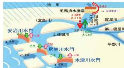
毛馬排水機場の位置と役割【資料提供：国土交通省 近畿地方整備局】 ※提供資料に説明追加
